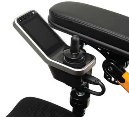
SE53A - abschwenkbare Steuerung mit Verriegelungspositionen
